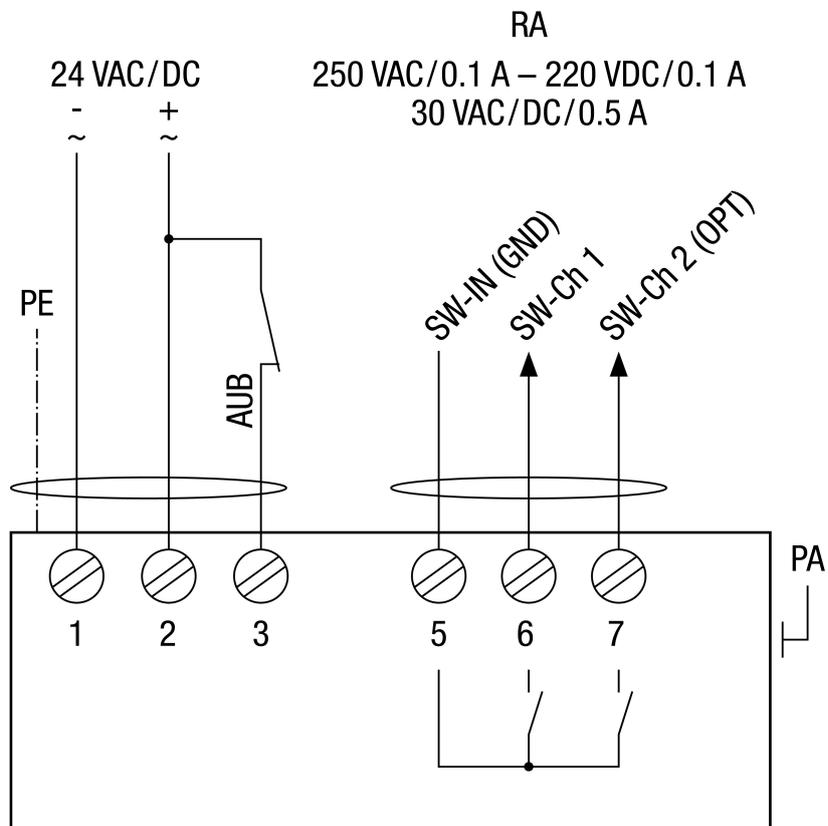
RA - Relaisausgang. Die Schaltfunktion Öffner oder Schließer kann nur per Menü eingestellt werden.
