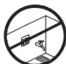
Der Thermostat darf nicht in feuchten Räumen angebracht werden. Platzieren Sie ihn in diesem Fall in einem angrenzenden Raum. Platzieren Sie den Thermostaten stets gemäß den lokalen IP-Schutzartvorschriften.
