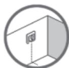
**Hinweis:** Ein Bodenfühler ermöglicht eine genauere Temperaturregelung und wird für alle Fußbodenheizungen empfohlen. In Verbindung mit Holzböden ist die Verwendung eines Bodenfühlers **vorgeschrieben**, um das Risiko einer Überhitzung des Fußbodens zu verringern.
