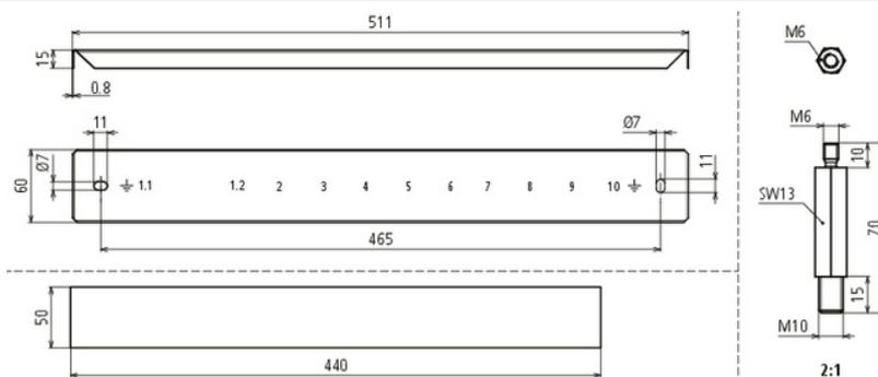
Abdeckung für zündfunkenfreie Ex-Potentialausgleichsschiene PAS EX. Mit Anschlussnummerierung und Bezeichnungsschild.
