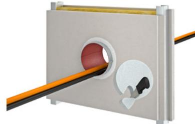
5. Stopfen komplett in Dicke  $\geq 2$  mm (TSD  $\geq 1$  mm) mit FLAMMOTECT-A oder BMK versiegeln.
