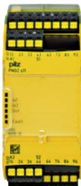
PNOZsigma Kontakterweiterung, Ausgänge: 8 S, 1 Ö, UB = 24 V DC, Breite: 45 mm, steckbare Federkraftklemmen, Kontaktblock zur Kontakterweiterung in Verbindung mit sicherheitsgerichteten Steuerungsteilen.
