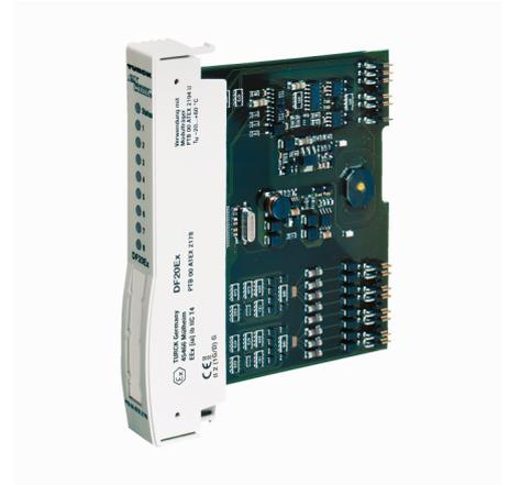
Das Eingangsmodul DF20EX ist mit acht Kanälen nach NAMUR ausgestattet, die zu zwei Blöcken zusammengefasst sind. Pro Block gibt es einen Frequenzeingang und drei Steuerein-/ausgänge.
