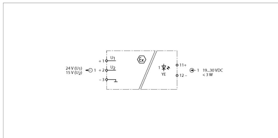
Der Ventil-Steuerbaustein vom Typ IM72-11EX/L stellt eine in Strom und Spannung begrenzte, eigensichere Ausgangsspannung bereit. Somit können Verbraucher im explosionsgefährdeten Bereich direkt angesprochen werden.
