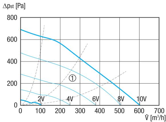
① Hilfskennlinien zu Steuerspannung 2 - 10 V
