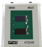
HT304N Duo Referenzzelle für Einstrahlungsmessung
