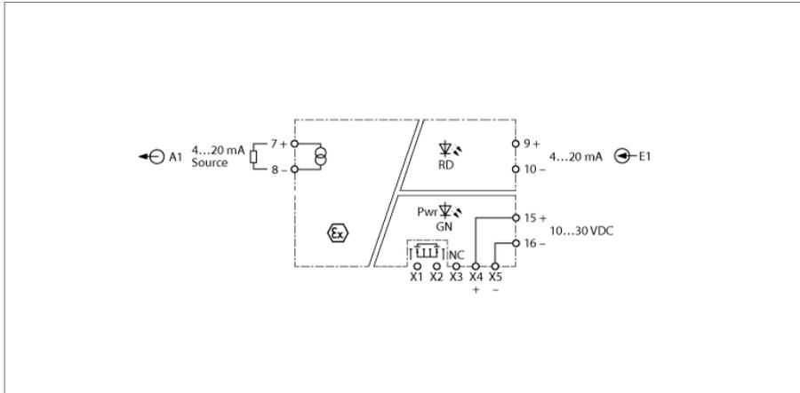
Über den 1-kanaligen Signaltrenner IMX12-AO01-1I-1I-HPR/24VDC/CC wird das normierte Stromsignal 1:1 galvanisch getrennt aus dem Nicht-Ex-Bereich in den Ex-Bereich übertragen. Neben dem Analogsignal können bidirektional auch digitale Signale der HART®-Kommunikation übertragen werden. Typische Anwendungen sind die Ansteuerung von I/P-Wandlern oder Anzeigegeräten im Ex-Bereich.
