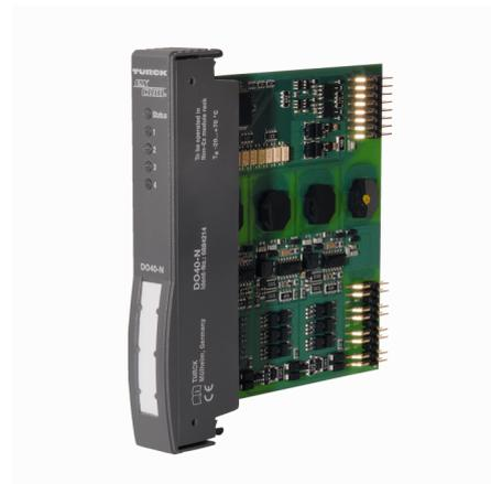
Das Ausgangsmodul DO40-N dient zum Anschluss von leistungsarmen Aktuatoren wie Ventilen oder Anzeigeelementen.
