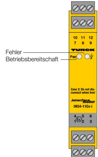
Mit dem 1-kanaligen Ex-Temperatur-Messverstärker des Typs IM34-11EX-I werden die temperaturabhängigen Änderungen von Ni100/Pt100-Widerständen, Thermoelementen der Typen B, E, J, K, L, N, R, S und T oder Kleinspannungen im Bereich von -100...+160 mV ausgewertet und als Stromsignale von 0/4...20 mA temperaturlinear ausgegeben.
