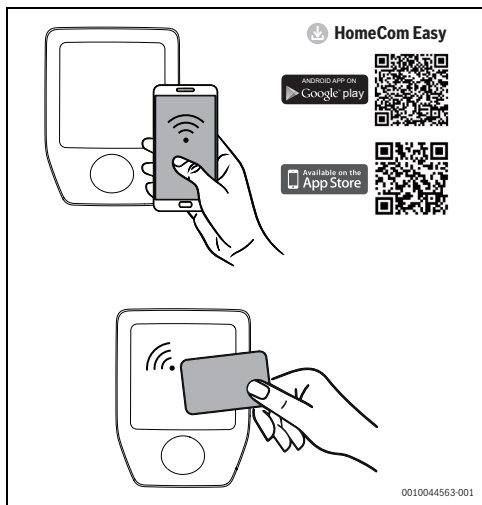
Fig. 216 Authentification avec la carte RFID
