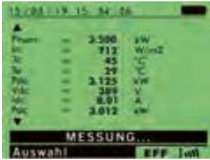
Messung / Aufzeichnung in der Funktion Leistungsanalyse
