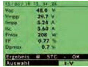
Messwertergebnis in Funktion I-U Kennlinienmessung
