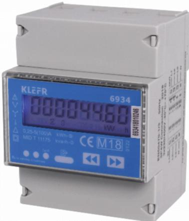
Der KL6934 MID ist ein hochwertiges, 3-phasisches, direkt angeschlossenes 100A-Messgerät, das in Verbindung mit den VESTEL Ladestationen der EVC04 Serie verwendet wird. Das Gerät misst Echtzeitwerte an der Hauptstromleitung und regelt über die ModBUS-Schnittstelle der EVC04 Ladestation den Ausgangsladestrom zum Elektrofahrzeug. Dadurch wird sichergestellt, dass der maximal verfügbare Gesamtstrom am Hausanschluss nicht überschritten wird.
