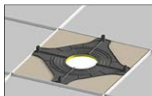
2. Einbauöffnung mit Hilfe der SpotClip-Plate als Schablone zuschneiden.
