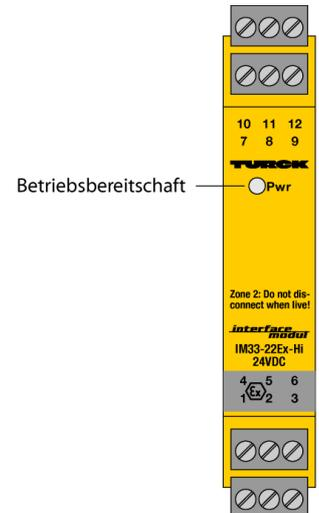
Über den 2-kanaligen HART®-Messumformer-Speisetrenner IM33-22EX-HI/24VDC werden eigensichere HART®-2-Draht-Messumformer (III) im Ex-Bereich betrieben und die Messsignale in den Nicht-Ex-Bereich übertragen. Neben den Analogsignalen können bidirektional auch die digitalen Signale der HART®-Kommunikation übertragen werden.
