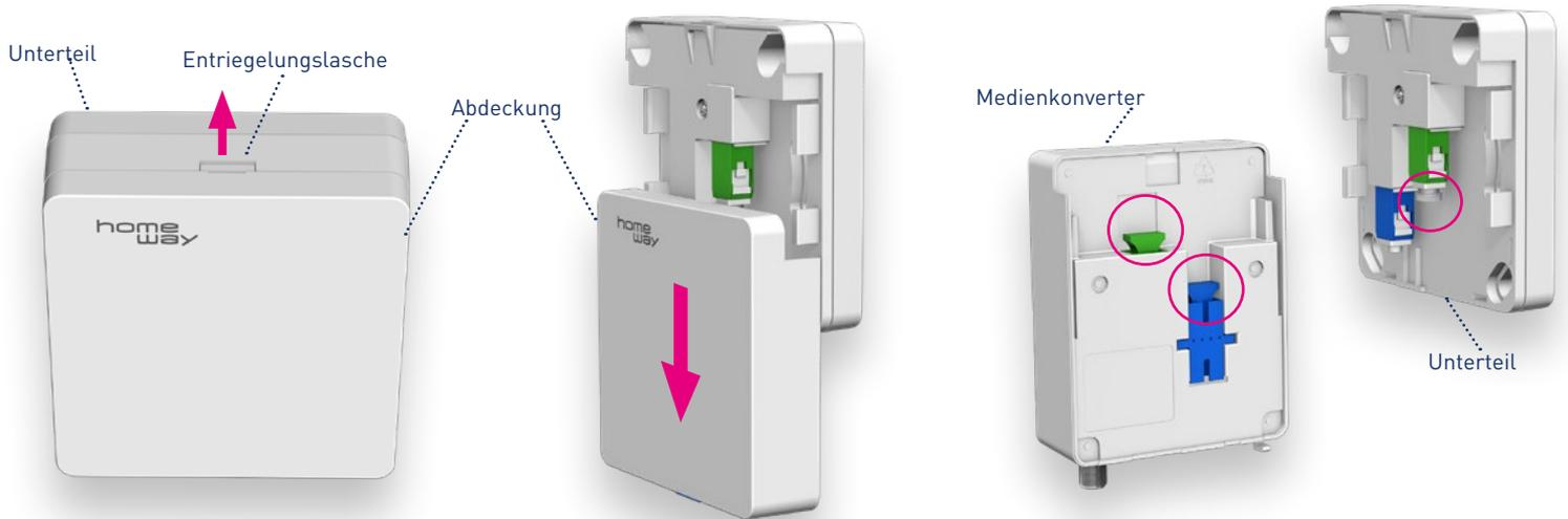
**1.** Die Abdeckung des OAP easy Install Kit lösen, die am Unterteil dafür vorgesehene Entriegelungslasche wird dabei nach hinten zur Wand gedrückt.
