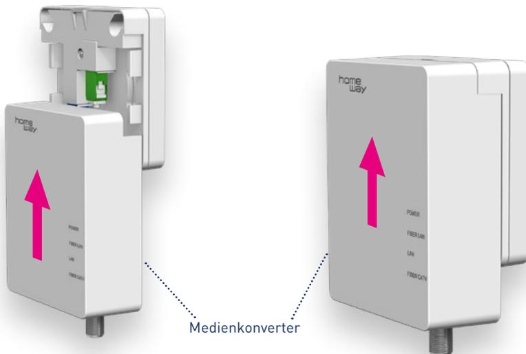
**4.** Medienkonverter am Unterteil ansetzen und über Schienenführung nach oben schieben. Dabei keinen Druck gegen das Unterteil ausüben.
