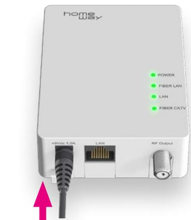
**6.** Den Stecker des mitgelieferten Netztes in den dafür vorgesehenen Anschluss am unteren Teil des Medienconverters stecken und das Netzteil an das Stromnetz anschließen. Keine anderen Netzteile verwenden!
