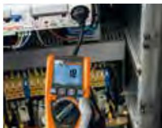
Impedanzmessung ohne RCD-Auslösung
