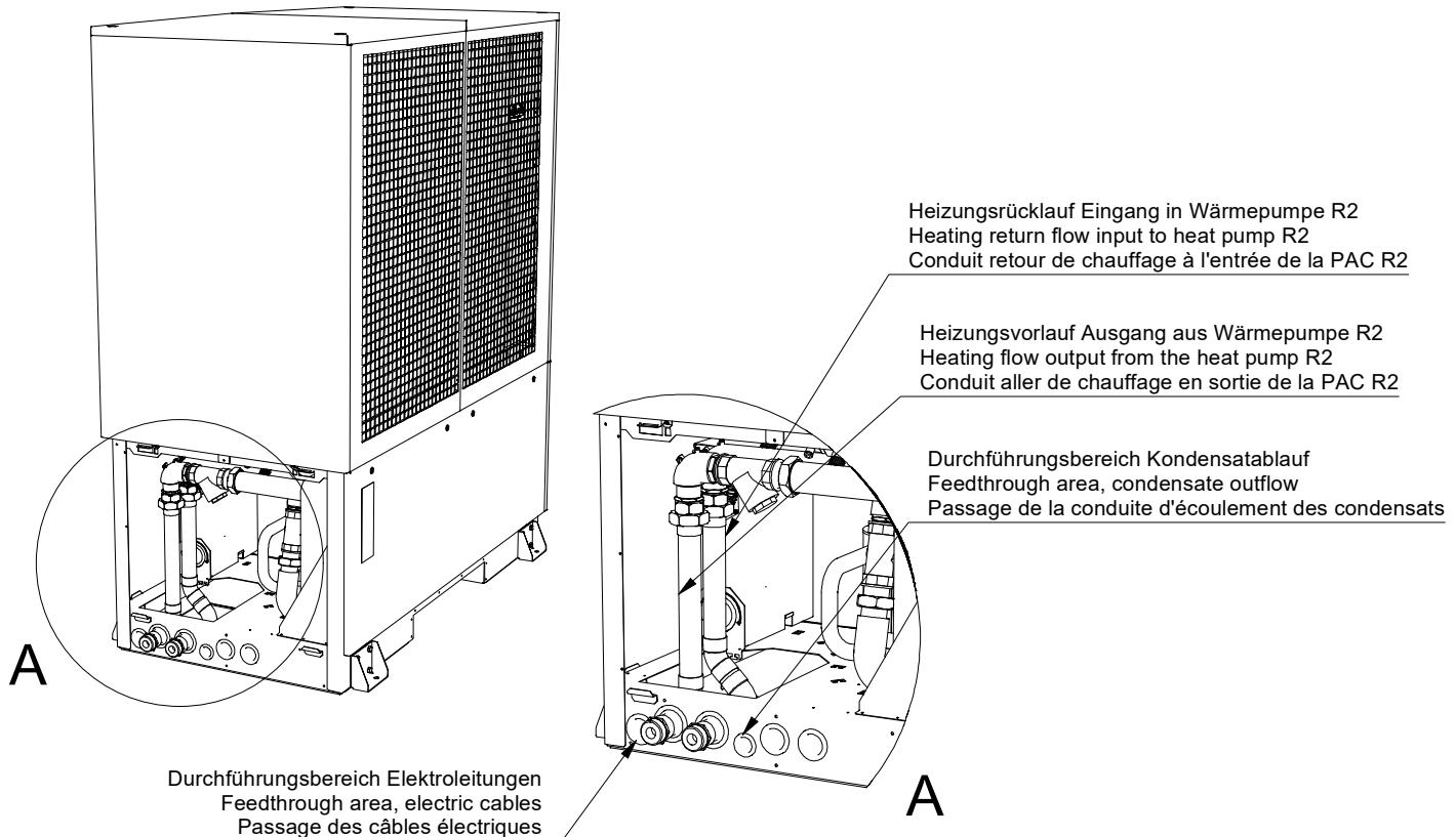
Die in der Skizze mit Pfeilen beschriebenen Rohre sind Bestandteil des Rohrbausatzes. Alle anderen dargestellten Elemente sind Bestandteil der Wärmepumpe.
