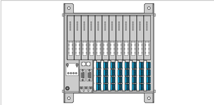
Der Modulträger MT08-3G besteht aus einer Backplane und dem eigentlichen Trägersystem. Er dient zur Aufnahme von zwei Gateways, zwei Netzteilen sowie 8 E/A-Modulen. Es können so bis zu 64 binäre Ein-/Ausgänge oder 32 analoge Ein-/Ausgänge bzw. jede Mischform an den Modulträger angeschlossen werden.
