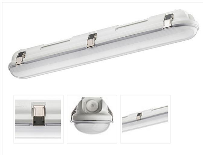
LED Feuchtraum Wannenleuchte aus weißem Polycarbonat (IK08, schlagfest) mit neuartiger, besonders schneller Montage. Durch smarten Aufbau wird die Installationszeit um ein Drittel verkürzt. Der LED Träger ist in der Abdeckung integriert. Inklusive bewährter Silikondichtung. Geeignet für die Decken-, Pendel- und waagerechte Wandmontage, Tragschienenmontage mit Zubehör möglich. Durchgangsverdrahtung möglich.
