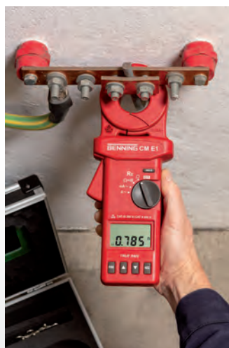
Mesure de la résistance de boucle de terre d'une prise de terre de l'installation
