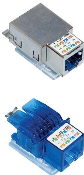
Das R&Mfreenet Kat.6 Anschlussmodul ist Bestandteil des Freenet Verkabelungssystem, ideal für Sprach-, schnelle Datenübertragungen und hohe Bandbreiten Anwendungen. Das Kat.6 Hochleistungsmodul ist perfekt für 1 Gigabit Ethernet (1GBASE-T) bis zu 250MHz und in der geschirmten Version bis zu 10 Gigabit Ethernet für Anwendungen bis zu 500MHz geeignet.
