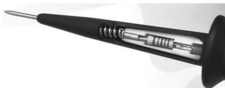
Deux résistances série montées immédiatement derrière chacune des deux pointes de touche et deux systèmes de contrôle au fonctionnement complètement indépendants garantissent le haut niveau de sécurité de cet appareil :
