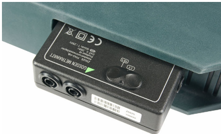
Bild 1 Ableitstrommessadapter am PROFITEST MXTRA
