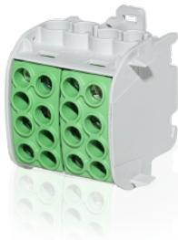
HLAK1p35Dgng; Hauptleitungsabzweigklemme, 1-polig, 35 mm<sup>2</sup>/Doppelblock ("PE"); Zugang 4 x 35 mm<sup>2</sup>, Abgang 4 x 25 mm<sup>2</sup>; Anschlüsse zertifiziert nach DIN VDE 0603-2; Mit Schnappbefestigung für waagerechte Montage
