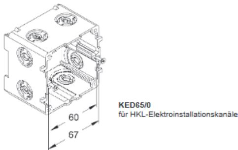
**1.** Die Geräteinbaudose KED65/0 auf die Befestigungsprofile (A) im Kanalboden aufrasten.
