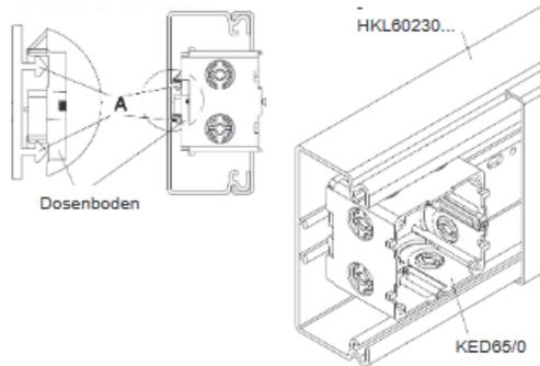
**3.** Geräteeinsatz verdrahten und mittels den Befestigungsschrauben (A) fixieren. Weiteres Anziehen senkt den Dosenrand ab und befestigt die Geräteinbaudose im Kanal. Die Montage der Steckdosen darf nur durch einen autorisierten Elektrofachmann erfolgen.
