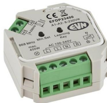
Der Funk-Dimmer-Empfänger kann über verschiedene Funk-Dimmer-Steuerelemente, aber auch über einen Taster (8V bis 230V/AC/DC) angesteuert werden. Somit können unterschiedliche Verbraucher bequem über Funk gedimmt werden. Natürlich können die angeschlossenen Verbraucher auch ein-/ausgeschaltet werden. Mögliche Funk-Sender sind EFDSP2, EFDHS3, EFDWP1 oder EFDWP4. Die maximale Leistung beträgt 200W für LED-Verbraucher sowie NV-Halogenleuchtmittel und 400W für HV-Halogenleuchtmittel.
