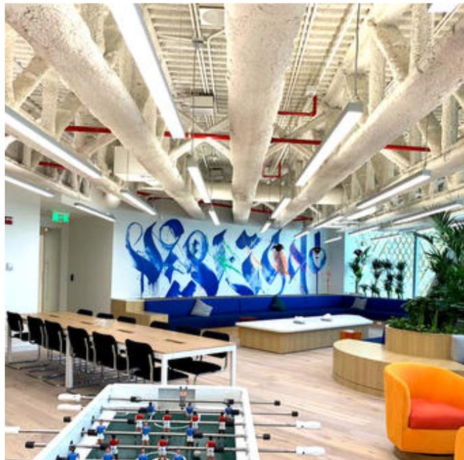
Matric-R6. LED. Lichtlinie für Pendelmontage. Beleuchtungskörper aus hochwertigem Aluminiumprofil. Oberfläche Silver Anodised. Lichtcharakteristik: Direkt-/ indirektstrahlend. Farbtemperatur: 4000K (Cool White). Farbwiedergabeindex (Ra): >80. Opaldiffusor für max. Transmissionsgrad bei homogener Auflösung der Lichtpunkte. Dimmbar DALI. LxBxH (rechteckig). L=2055mm. B=81mm. H=60mm. Y-Seilabhängung mit Baldachin und Zuleitung (Set). Pendellänge max 1500mm.
