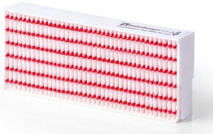
Original-Ersatzfilter für dezentrale Wohnraumlüftungsgeräte WRL-K75 und WRL-K90 Typ: WRL-KF7, Filterklasse F7 (DIN 779:2012), bzw. ISO ePM10 85%/ISO ePM2,5 50% (ISO16890), Rahmen aus PET, Filtermedium PP plissiert, mit Auszugslasche, für Außenluft, Abmessung: 151x65x25mm
