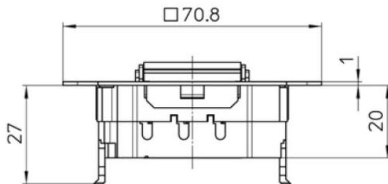
**Wechselschalter 2polig UP**
