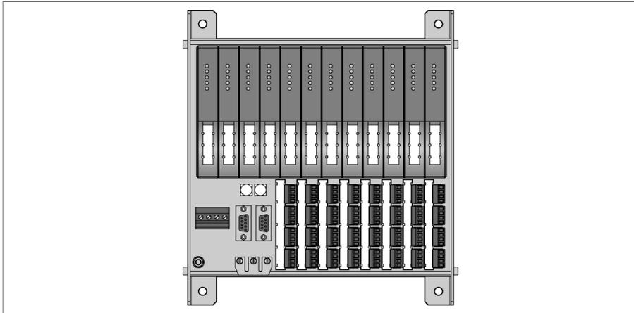
Der Modulträger MT08-N besteht aus einer Backplane und dem eigentlichen Trägersystem. Er dient zur Aufnahme von zwei Gateways, zwei Netzteilen sowie 8 E/A-Modulen. Es können so bis zu 64 binäre Ein-/Ausgänge oder 32 analoge Ein-/Ausgänge bzw. jede Mischform an den Modulträger angeschlossen werden.
