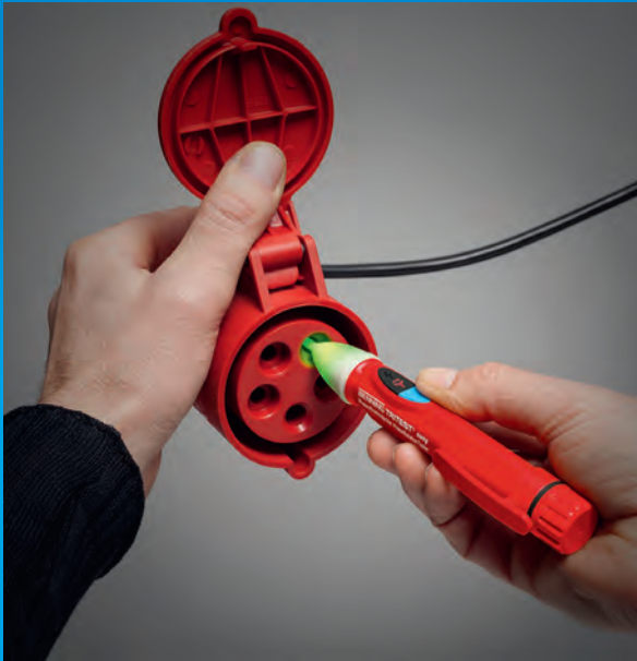
Drehfeldrichtungsprüfung an CEE-Kupplung mit TRITEST® easy
