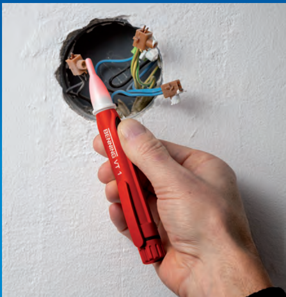
Phasenprüfung an Abzweigdose mit BENNING VT 1
