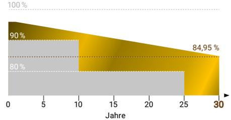
■ Lineare Leistungsgarantie für Glas-Glas Solarmodule
