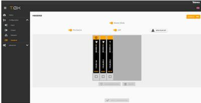
Konfiguration eines der Module als Master der gesamten Kopfstation. Als Master kann jedes beliebige Modul ausgewählt werden. Sobald der Master-Modus aktiviert ist, sucht die Einheit nach anderen an das Netzwerk angeschlossenen Einheiten (ETH2).
