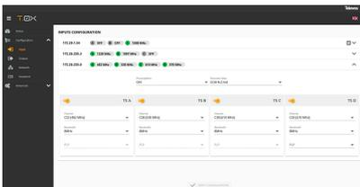
Das Gerät verfügt über vier Demodulatoren (TS A, TS B, TS C, TS D) die an einen einzelnen Eingang angeschlossen sind. Das Gerät arbeitet immer im Loop-Modus.
