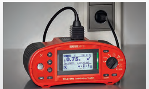
IT 115 bei der Schleifenimpedanzmessung ohne RCD-Auslösung
