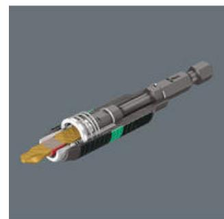
Die Wirkungsweise des BiTorsion-Systems basiert auf der Kombination von zwei schockabsorbierenden Feder-Elementen. Sowohl Bits als auch Halter weisen eine federnde Torsionszone auf, die bei Belastungsspitzen kinetische Energie aus der Abtriebsspitze ableitet.
