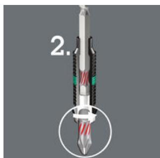
Größere Belastungsspitzen werden durch die Torsionswirkung des Bit-Schaftes minimiert (Phase 2). Diese Wirkung wird durch eine gezielte Sonderwärmbehandlung nach dem Härteprozess des Bits erzielt. Dadurch wird die Härte des Schafes gegenüber der Abtriebsspitze reduziert.
