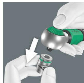
Die Kugelarretierung sorgt für sicheren Sitz der Nüsse und des Zubehörs und damit auch für verlässliche Sicherheit während des Verschraubens. Ein kurzer Druck auf den Auslöseknopf auf dem Kopf der Knarre und die Kugelarretierung wird gelöst.
