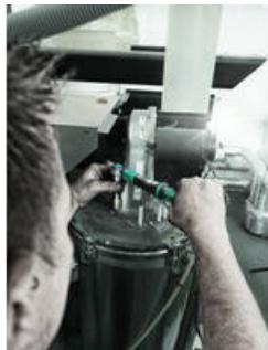
Der Drehmomentschlüssel Safe-Torque A 1 hat eine 1/4" Vierkantaufnahme und ist für 1/4" Steckschlüsseleinsätze geeignet.
