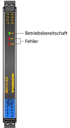
Über den 2-kanaligen Signaltrenner IMX12-AO01-2I-2I-H0/24VDC wird das normierte Stromsignal 1:1 galvanisch getrennt aus dem Nicht-Ex-Bereich in den Ex-Bereich übertragen. Neben dem Analogsignal können bidirektional auch digitale Signale der HART®-Kommunikation übertragen werden. Typische Anwendungen sind die Ansteuerung von I/ P-Wandlern oder Anzeigegeräten im Ex-Bereich.
