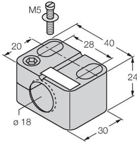
Befestigungsschelle für Gewinderohrsensoren, mit Festanschlag; Werkstoff: PA6
