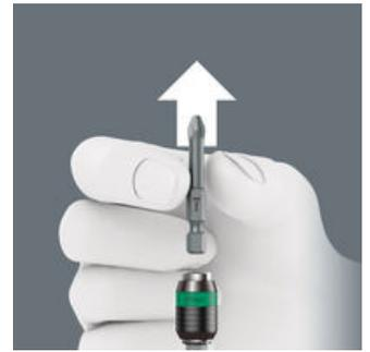
Zum Bitwechsel einfach die Hülse nach vorne schieben: Dabei hebt der Federmechanismus den Bit vom Magneten ab und entriegelt das Werkzeug. Der Bit kann problemlos entnommen werden. Besonders hilfreich: Mühelose Entnahme auch kleinster Bitgrößen ohne Hilfswerkzeug.
