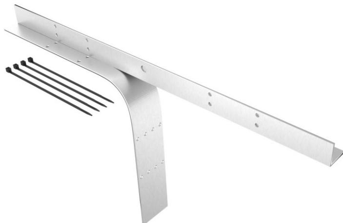
T-Traverse aus Edelstahl V2A Typ: ESTT, als komfortabler und sicherer Kantenschutz bei Fallrohren für Dachrinnenheizungen und zum Abhängen von Heizkabel und Heizbänder in Verbindung mit Nylonseil und Zugentlastungsschellen, einschl. 4 Stück Kabelbinder 140 mm
