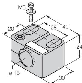
Befestigungsschelle für Gewinderohrsensoren, mit Festanschlag; Werkstoff: PA6
