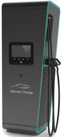
Die HYC 400 CCS Schnellladestationen verfügen über zwei Ladepunkte nach CCS2-Standard. Die Ladekabel sind für eine Stromstärke von 500A ausgelegt und können im Boost-Mode bis zu 600A übertragen. Der Charger bietet eine hochintegrierte Systemlösung. Das robuste Gehäuse schützt die integrierte Leistungselektronik nach IP54 optimal gegen Staub und Spritzwasser. Der HYC 400 kann in verschiedenen Leistungsvarianten konfiguriert werden.
