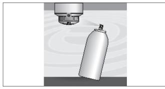
Nach der Installation sollte die einwandfreie Funktion des Rauchschalters mit Prüfaerosol getestet werden. Hierzu sind die aufgedruckten Sicherheitshinweise auf der Prüfflasche 918/5 zu beachten.
