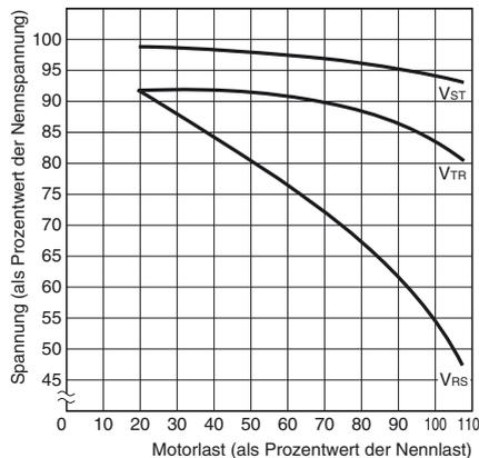
**Hinweis:** Bei Phasenausfall von Phase R: V<sub>ST</sub>, V<sub>TR</sub> und V<sub>RS</sub> geben die Spannung der Motorklemmen bei Phasenausfall an.
