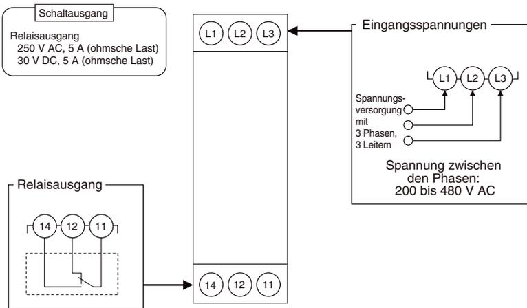
**Hinweis:** Verwenden Sie die empfohlenen Aderendhülsen, wenn Sie verdrehte Kabel einsetzen.
