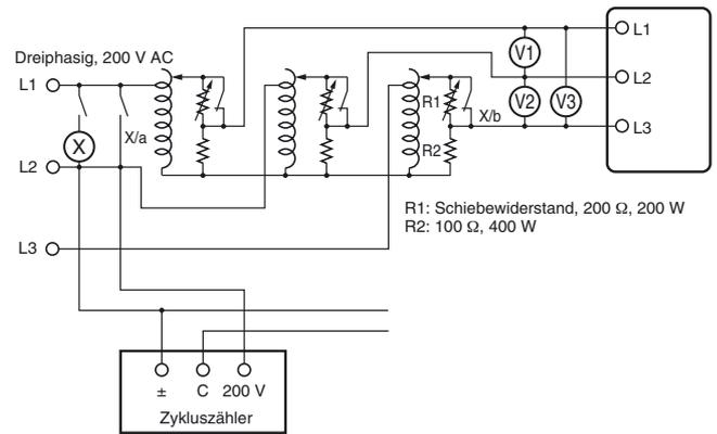
**Q** Prüfung des Phasenlage- und Phasenausfallbetriebs
