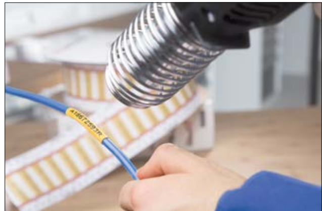
TLFD DS – halogenfreie und flüssigkeitsbeständige Schrumpfschlauchmarkierer.
