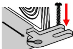
6 Deckel schließen und die 4 Deckelschrauben zudrehen.
