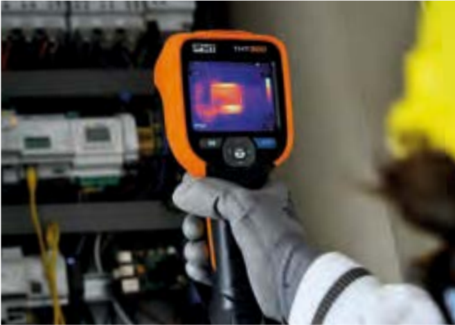
Ein überhitzer Lüftermotor aufgenommen mit der THT300
